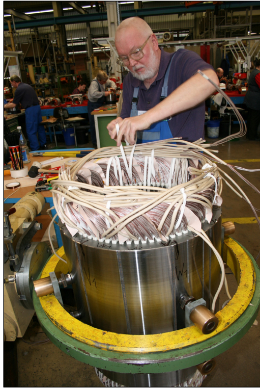
Auch Groß-Motoren mit mehreren hundert KW Leistung für die Unterwassermotorpumpen werden im Werk Halle gefertigt.
