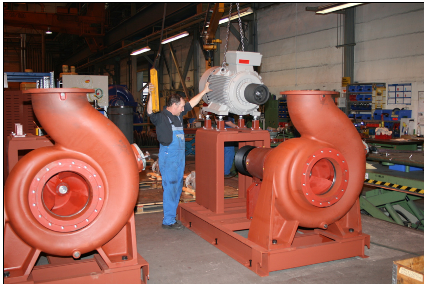
Endmontage von großen Abwasserpumpen
